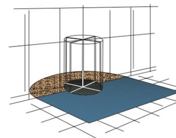
▲ Resultado perfectamente integrado y nivelado combinando moquetas exteriores e interiores con alfombrillas de limpieza.
